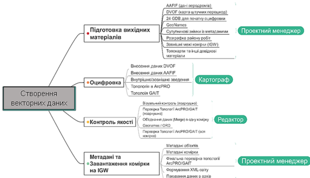
Рис. 2. Схема створення векторних геопросторових даних
