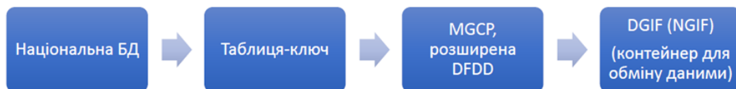
Рис. 1. Схема конвертації національних даних у структуру MGCP
