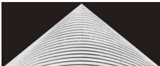
Рис. 2. Фотознімок сімейства ізоліній на поверхні конуса, отриманих проектуванням лінійного растра паралельним пучком променів коліматора
